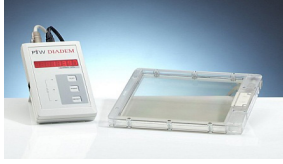
Hình 1: Buồng ion hóa đo DAP và bộ hiển thị
